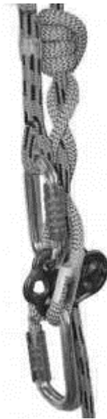
Sistema di frizione per lavorare su corda, composto di cordino OP lungo 80 cm, carrucola a tre punti di ancoraggio e 2 moschettoni OK.
