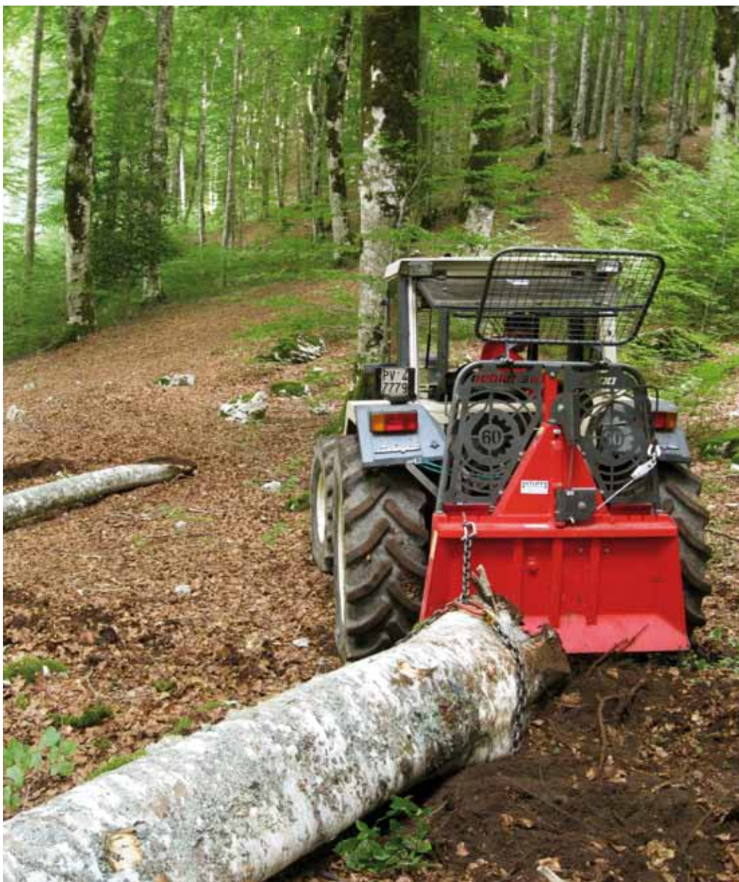
Foto 48 Concentramento con trattore di un fusto sramato non sezionato
